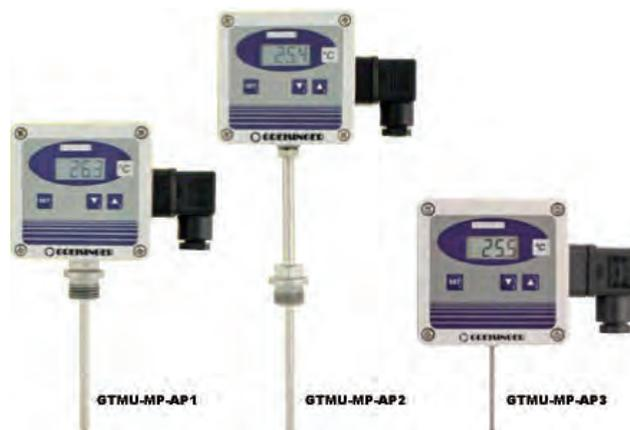
GTMU-MPシリーズは測定範囲-50℃から+400℃の、Pt1000/2線式センサを使用した温度変換器です。幅広い用途に使用でき、本体は現場で温度を確認できるディスプレイ付きです。出力信号は自在にスケーリング可能です。プローブはプロセス直結式、可動取付けネジ付、壁掛け型の3種類から選択できます。
