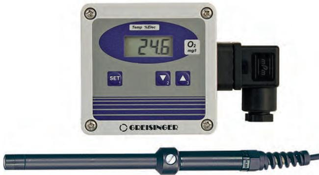
OXY3610MPは最長30mまでのケーブル長での測定ができる溶存酸素トランスミッタです。センサはガルバニ電池式で、流速0.3m/s以上の流れが必要となります。電極に温度センサが内蔵されており、自動で温度補正を行います。センサの校正は大気の1点で行います。
